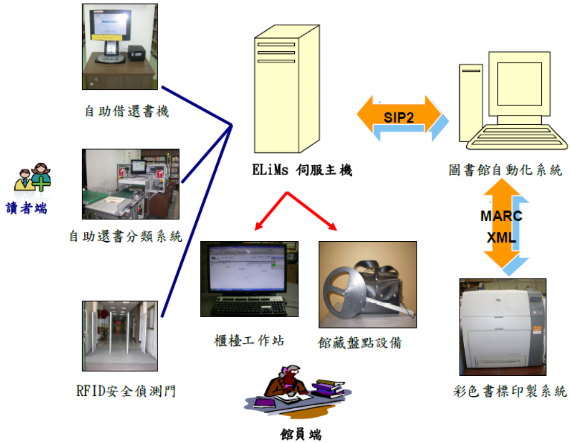
圖 7 國中圖 RFID 館藏流通系統架構圖
